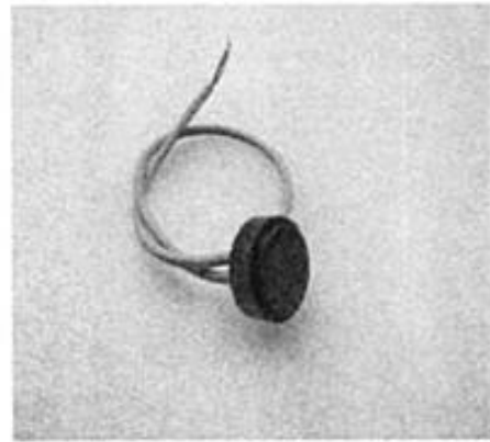
图2 超声波换能器实物图
