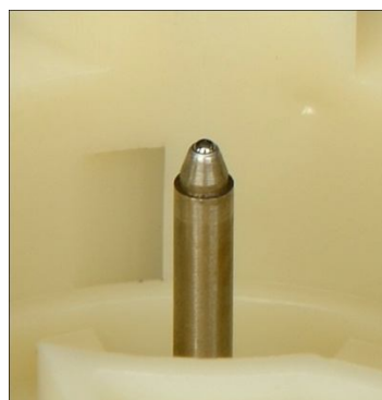
图5 (b) 美国表叶轮盒顶尖细节图
