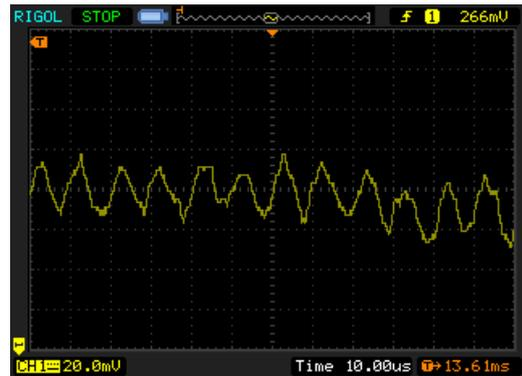
图 8 调制信号驱动模块输出波形
