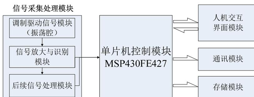
图2 射流电子水表电子电路框图
