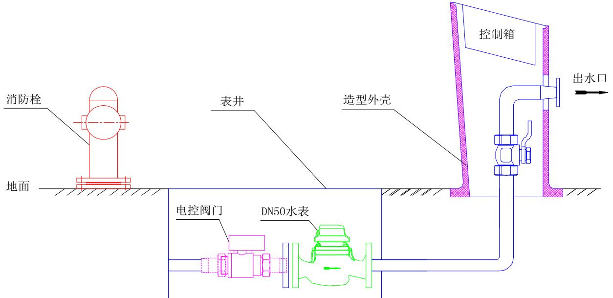
水表无线远程监控系统是由带脉冲输出的 DN50 水表、电控阀门、控制器和造型外壳以及后台管理系统等构成。各用水单位持合法有效的用户卡放入控制箱后，控制器自动判断其有效性，通过验证后，电控阀门开启，用户连接管件，并打开手动阀门开始用水。用水完毕后，关闭手动阀门，取出用户卡，电控阀门自动关闭，控制器自动将本次用水信息通过 GPRS 上传至管理中心后台管理系统。用水信息涵盖了卡号、用水单位、控制箱设备号，开关阀时间，用水量等。管理中心将本次用水信息通过后台管理系统短消息至用户，并且月末出帐单与各用水单位结算。
